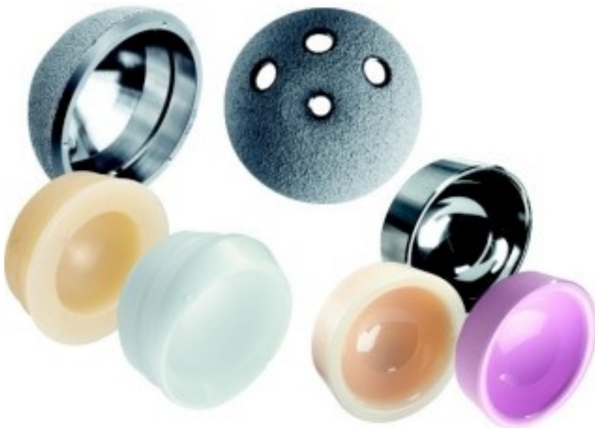
Figura 2.1: In alto coppa acetabolare in metallo poroso in cui possiamo apprezzare (a dx) i fori per l'introduzione di viti per incrementare il fissaggio; in basso differenti tipologie di inserti in polietilene ad alto peso molecolare, in ceramica e in acciaio.
