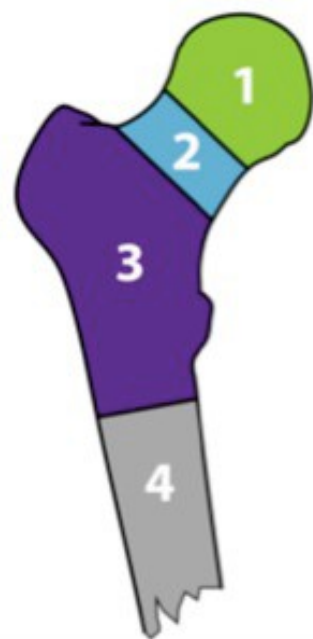
Figura 2.19: secondo la classificazione della JISRF vi sono 4 regioni in cui lo stelo può raggiungere la stabilità primaria.
