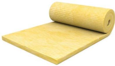
*Produzione:* la lana di vetro è costituita da una serie di materiali fusi insieme, a temperature che variano dai 1300 ai 1500 °C, e sono: vetro riciclato per l'80%, silice, sabbia, calcare, carbonato di sodio e boro.
