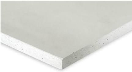
*Produzione:* i pannelli a base di calcio silicato vengono prodotti solo con elementi naturali come: ossido di calcio, silice e fibre di cellulosa. Questi materiali vengono mescolati in un impasto che passa in autoclave e, dopo un lungo periodo sotto pressione ad alte temperature, il composto saturo d'acqua passa all'essiccazione dove perde circa il 75% del suo peso.
