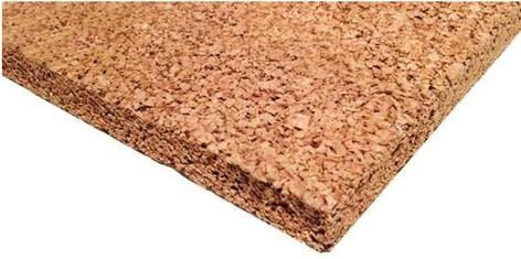
*Produzione:* il sughero espanso viene prodotto esclusivamente in versione pura, ovvero la corteccia della quercia da sughero viene prima macinata per poi riporre il granulato ottenuto all'interno di un serbatoio per cuocerlo a pressione con vapore acqueo alla temperatura di circa 370°C. Durante questo processo il sughero si espande del circa 20, 30% e si lega grazie alla propria resina, senza l'aggiunta di altre sostanze.
