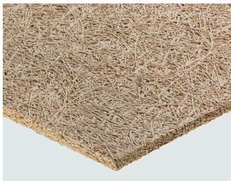
*Produzione:* nella fase preliminare della produzione della lana di legno le fibre lignee di abete rosso vengono sottoposte ad un trattamento mineralizzante che lascia invariate le caratteristiche del prodotto ma ne annulla i processi di deterioramento biologico. Successivamente si unisce come se fosse un impasto il 65% di fibre lignee con il 35% di carbonato di calcio e cemento Portland, che servono da collante per le fibre, al fine di ottenere un prodotto che, dopo un
