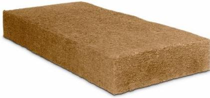
*Produzione:* i pannelli in fibre di legno vengono realizzati con legno di abete rosso o di pino che viene frantumato e scomposto in fibre di legno fini mediante procedimenti termici e meccanici. Successivamente si ha la loro pressatura, intreccio e infeltrimento con l'aggiunta di allume che gli conferisce la stabilità
