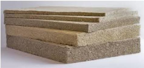
*Produzione:* le piante di canapa, una volta raccolte vengono ridotte in fibra e successivamente lavorate con l'aggiunta di fibre di poliestere e materiali ignifughi. Con processi meccanici e di termolegatura si ottengono i pannelli senza l'utilizzo di acqua e prodotti chimici al fine di ottenere un prodotto estremamente naturale.
