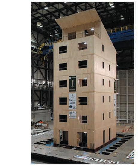
EDIFICIO IN XLAM SOTTOPOSTO A PROVE SISMICHE
